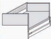
В комплекте: 1 Царги “М” Л.+П. 650 мм **378M6502S**, 2 Заглушки Л.+П. **ZAA.230N**, 3 Направляющие с BLUMOTION Л.+П. 650 мм на 50 кг **559.6501B**, 4 Угловые крепления задней стенки “D” Л.+П. **Z30D000SL.45**, 5 Релинги симм. **ZRG.596V**, 6 Двустенные боковины BOXSIDE **Z37H618**, 7 [PUB] Угловые передние крепления “D” Л.+П. **ZSF.345E** / [PUBS] Комплект SYNCROMOTION “D” **Z33D00E**.
