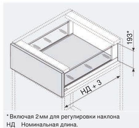
\* Включая 2 мм для регулировки наклона
