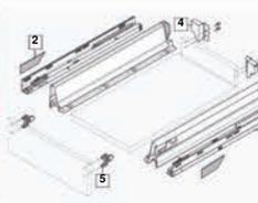
В комплекте: [1] Царги “N” Л.+П. **378Nxx02S**, [2] Заглушки Л.+П. **ZAA.230N**, [3] Направляющие с BLUMOTION Л.+П. на 30 кг **558.xx01B**, [4] Крепления задней стенки “N” Л.+П. **Z30N000S**, [5] Крепления фасада INSERTA симм. **ZSF.3902**.
