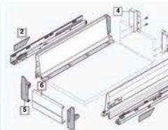
В комплекте: 1 Царги “К” Л.+П. 378Кхх02S, 2 Заглушки Л.+П. ZAA.230N, 3 Направляющие с BLUMOTION Л.+П. на 30 кг 558.xx01B, 4 Крепления задней стенки “К” Л.+П. Z30K000S, 5 Держатели пер. панели ZIF.70K0, 6 Передняя панель Z31A1081A. Лотки см. стр. 49.
