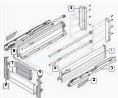
В комплекте: 1 Царги “М” Л.+П. 378Мхх02S, 2 Заглушки Л.+П. ZAA.230N, 3 Направляющие с BLUMOTION Л.+П. на 30 кг (600, 650 мм – 50 кг) 55X.xx01B, 4 Крепления задней стенки “D” Л.+П. Z30D000S, 5 Релинги (4 шт.) симм. ZRG.xxxV, 6 Держатели пер. панели ZIF.73D0, 7 Передняя панель Z31A1081A, 8 Попер. релинг 1104мм ZRG.1104U, 9 Ручка для пер. панели ZIF.7008. Разделители см. стр. 38.
