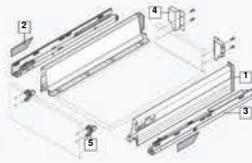
В комплекте: [1] Царги “М” Л.+П. 378Мхх02S, [2] Заглушки Л.+П. ZAA.230N, [3] Направляющие с BLUMOTION Л.+П. на 30 кг (600, 650 мм – 50 кг) 55X.xx01B, [4] Крепления задней стенки “М” Л.+П. Z30M000S, [5] Крепления фасада INSERTA симм. ZSF.3902.
