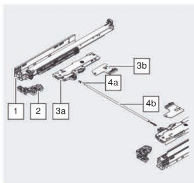
TIP-ON BLUMOTION объединяет в себе удобство открывания ящиков без ручек, характерное для TIP-ON и мягкое и бесшумное закрывание благодаря BLUMOTION.
