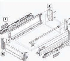
В комплекте: [1] Царги “M” Л.+П. **378Mxx02S**, [2] Заглушки Л.+П. **ZAA.230N**, [3] Направляющие с BLUMOTION Л.+П. на 30 кг (600, 650 мм – 50 кг) **55X.xx01B**, [4] Крепления задней стенки “B” Л.+П. **Z30B000S**, [5] Реллинги симм. **ZRG.xxxV**, [6] Держатели пер. панели **ZIF.72B0**, [7] Передняя панель<sup>1</sup> **Z31A1081A**.
