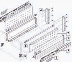
В комплекте: [1] Царги “М” Л.+П. 378Мхх02S, [2] Заглушки Л.+П. ZAA.230N, [3] Направляющие с BLUMOTION Л.+П. на 30 кг (600, 650 мм – 50 кг) 55X.xx01B, [4] Крепл. задней стенки “D” Л.+П. Z30D000S, [5] Крепл. фасада INSERTA симм. ZSF.3902, [6] Реллинги симм. (2 шт.) ZRG.xxxV, [7] Одностенные боковины BOXSIDE Z36HxxxS. Разделители см. стр. 38.
