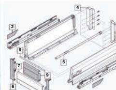
В комплекте: 1 Царги “К” Л.+П. 378Кхх02S, 2 Заглушки Л.+П. ZAA.230N, 3 Направляющие с BLUMOTION Л.+П. на 30 кг 558.xx01B, 4 Крепления задней стенки “С” Л.+П. Z30C000S, 5 Релинги симм. ZRG.xxxV, 6 Держ. панели ZIF.72C0, 7 Передняя панель Z31A1081A, 8 Попер. релинг ZRG.1104U, 9 Ручка для пер. панели ZIF.7008. Разделители см. стр. 38.
