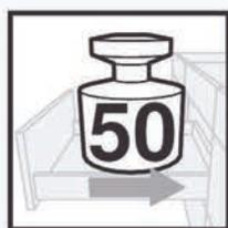
Ящики в корпусах > 900 мм и ящики с высоким фасадом для тяжёлого содержимого необходимо оснащать направляющими на 50 кг [559.xx01B](#).
