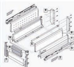
В комплекте: 1 Царги “М” Л.+П. 378Мхх02S, 2 Заглушки Л.+П. ZAA.230N, 3 Направляющие с BLUMOTION Л.+П. на 30 кг (600, 650 мм – 50 кг) 55X.xx01B, 4 Крепления задней стенки “D” Л.+П. Z30D000S, 5 Релинги симм. ZRG.xxxV, 6 Боковина BOXSIDE Л.+П. Z37HxxxS, 7 Держатели пер. панели ZIF.73D0, 8 Передняя панель Z31A1081A, 9 Попер. релинг 1104мм ZRG.1104U, 10 Ручка для пер. панели ZIF.7008. Разделители см. стр. 38.
