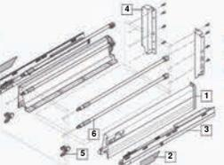
В комплекте: [1] Царги “М” Л.+П. 378Мхх02S, [2] Заглушки Л.+П. ZAA.230N, [3] Направляющие с BLUMOTION Л.+П. на 30 кг (600, 650 мм – 50 кг) 55X.xx01B, [4] Крепления задней стенки “D” Л.+П. Z30D000S, [5] Крепления фасада INSERTA симм. ZSF.3902, [6] Реллинги симм. (4 шт.)<sup>2</sup> ZRG.xxxV.
