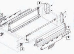
В комплекте: [1] Царги “М” Л.+П. 378Мхх02S, [2] Заглушки Л.+П. ZAA.230N, [3] Направляющие с BLUMOTION Л.+П. на 30 кг (600, 650 мм – 50 кг) 55X.xx01B, [4] Крепления задней стенки “В” Л.+П. Z30B000S, [5] Крепления фасада INSERTA симм. ZSF.3902, [6] Реллинги симм.<sup>2</sup> ZRG.xxxV.
