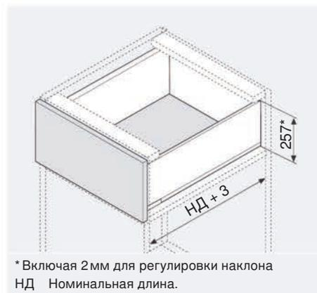
\* Включая 2 мм для регулировки наклона
