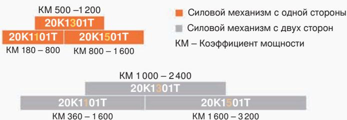
В пересекающихся областях для выбора силового механизма рекомендуется пробная установка.
