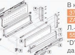
В комплекте: [1] Царги “М” Л.+П. 378Мхх02S, [2] Заглушки Л.+П. ZAA.230N, [3] Направл. с BLUMOTION Л.+П. на 30 кг (600, 650 мм – 50 кг) 55X.xx01B, [4] Крепления задней стенки “D” Л.+П. Z30D000S, [5] Крепления фасада INSERTA симм. ZSF.3902, [6] Реллинги симм. (2 шт.) ZRG.xxxV, [7] Двуст. боковины BOXSIDE Z37HxxxS. Разделители см. стр. 38.
