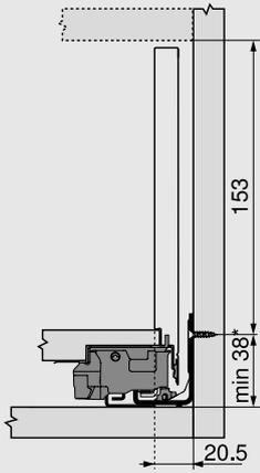
\* + 1 мм при монтаже направляющей до сборки корпуса
