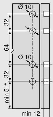
\* + 1 мм при монтаже направляющей до сборки корпуса
