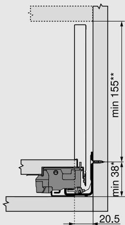
Установочные размеры для монтажа фасада под саморезы
