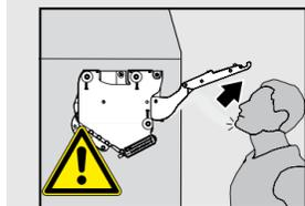
Существует опасность получения травмы при выскакивании рычага!
