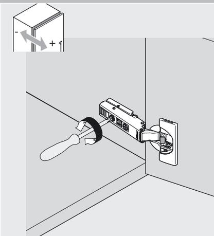
Регулировка по глубине
