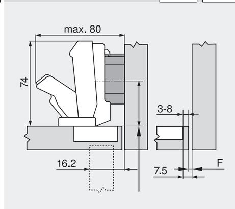
Расстояние (от края) до места крепления ответной планки увеличивается на толщину двери + 1.5 мм
