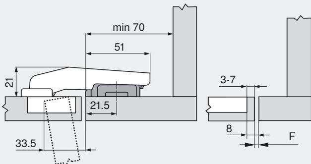
Стандартное расстояние от края до места крепления ответной планки на фальшпанели уменьшается на 15.5 мм (= 21.5 мм)!
